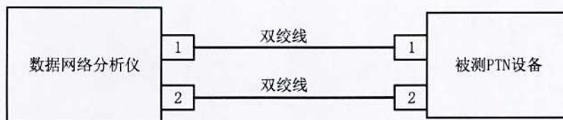
图7 接口传输距离、半双工-全双工自动协商测量框图
