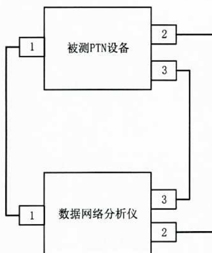
图15 MAC 地址黑名单、风暴抑制、镜像功能测量框图
