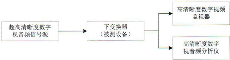
图 1 接口类型 SDI 接口、信号格式变换、映射模式、超白电平、3D LUT 表导入测量框图
